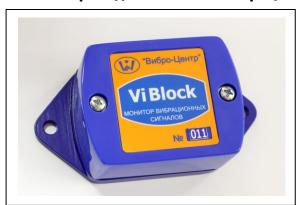
Система вибрационного мониторинга марки ViBlock является компактным устройством, предназначенным для контроля вибрации, температуры, диагностики дефектов вращающегося оборудования, в том числе подшипников качения. Финальной функцией работы системы ViBlock является выдача практических рекомендаций по управлению эксплуатацией и ремонтами оборудования.
