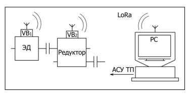
Если в приводе кранового механизма электродвигатель и редуктор конструктивно объединены в единый агрегат, то на его корпусе достаточно установить только один прибор марки ViBlock, который будет эффективно выявлять критический подшипник механизма и контролировать изменение его состояния.
