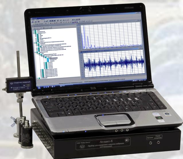
Многоканальный синхронный регистратор - анализатор вибросигналов «Атлант-8/16/32» является современным прибором, предназначенным для решения наиболее сложных задач в вибрационной диагностике состояния оборудования. В зависимости от требований Заказчика прибор может поставляться в 8, 16 или 32 канальном исполнении.
