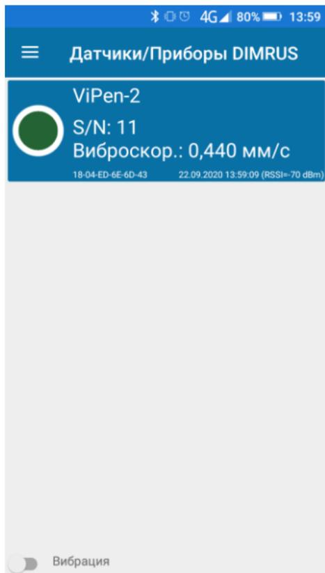
Для управления прибором и просмотра результатов измерений используется программа «Датчики Димрус» (Dimrus Sensor Manager).
