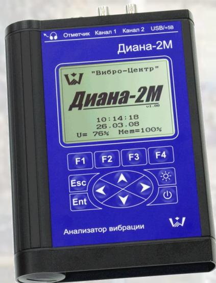
Анализатор вибрации двухканальный «Диана-2М» (виброанализатор) предназначен для оперативного решения задач вибрационной диагностики и виброналадки вращающегося оборудования различных типов.
