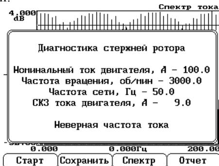
Рисунок 19. Диагностика стержней ротора
