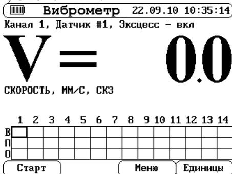
Рисунок 3.Экран прибора в режиме виброметра
