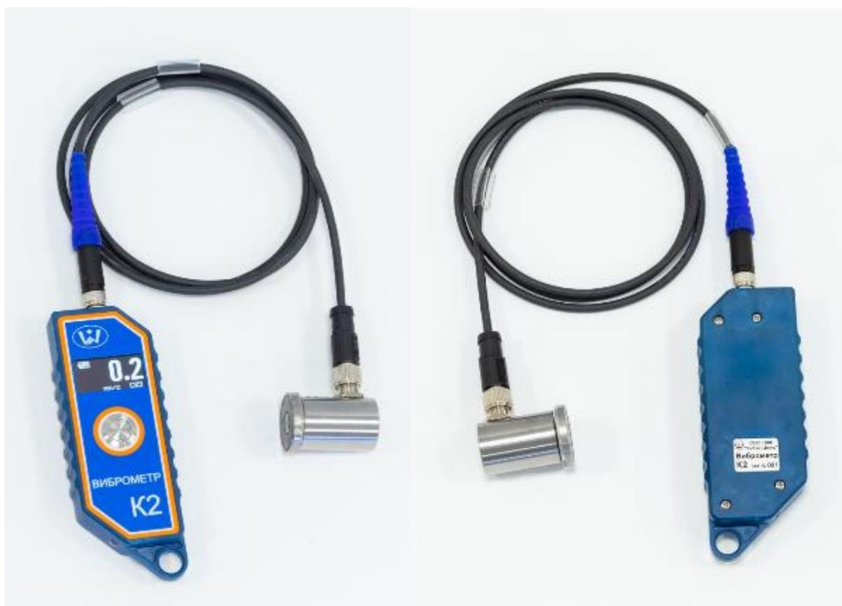
Рисунок 2 –Общий вид приборов для измерения виброскорости Виброметр-K2
