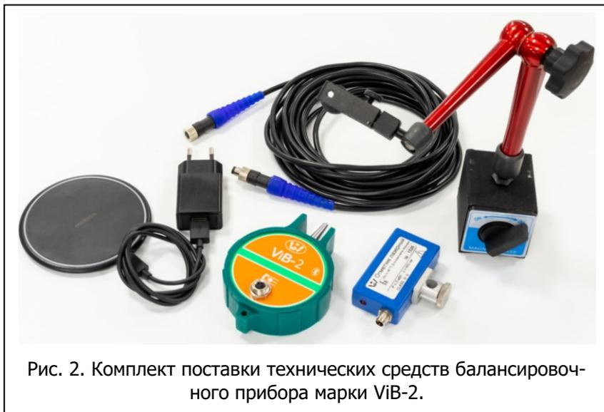
Рис. 2. Комплект поставки технических средств балансировочного прибора марки ViB-2.
