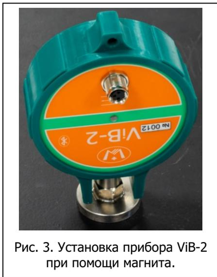
Рис. 3. Установка прибора ViB-2 при помощи магнита.
