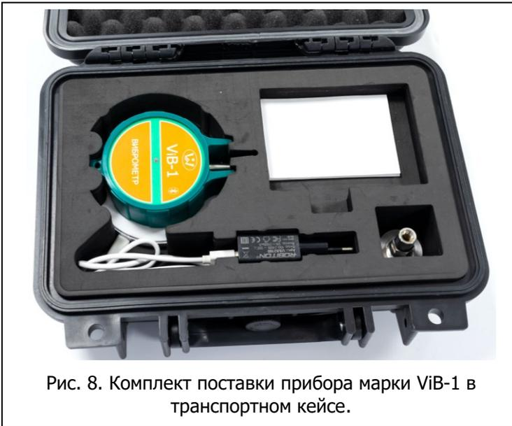
Рис. 8. Комплект поставки прибора марки ViB-1 в транспортном кейсе.
