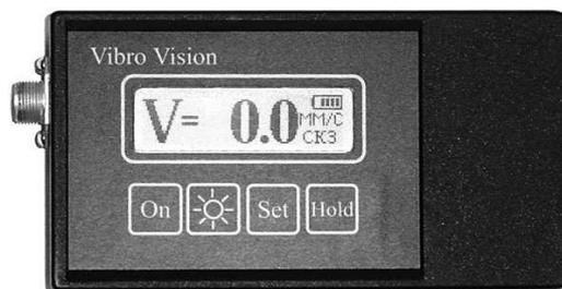
Прибор «Vibro Vision» заключен в пластмассовый корпус, имеет жидкокристаллический дисплей с разрешением 122x32 точки и пленочную защищенную клавиатуру. Клавиатура, предназначенная для управления всеми функциями прибора, включает в себя 4 кнопки:
