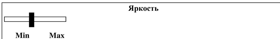
Вид экрана в этом режиме показан на рисунке выше. Кнопка **“Set”** служит для уменьшения яркости, **“Hold”** – для увеличения яркости экрана. Одновременное нажатие кнопок **“Set”** и **“Hold”** – возврат из меню настройки яркости экрана в меню настроек с сохранением текущего значения яркости.
